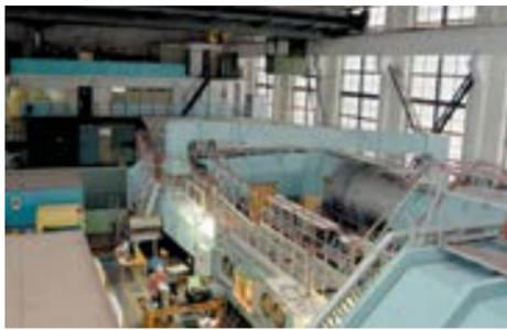
Аэродинамическая труба Т-324 Института теоретической и прикладной механики им. С.А. Христановича СО РАН служит для проведения экспериментов на скоростях меньших, чем скорость звука.
