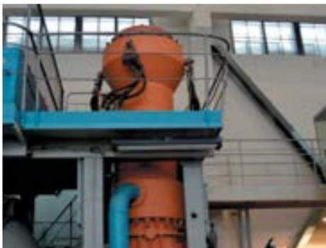
Это – аэродинамическая труба Т-313. Здесь изучают аэродинамику моделей летательных аппаратов: по трубе пускают поток газа и смотрят, как от моделей отрываются пограничные слои.
